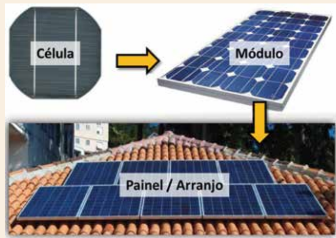
Figura 4: Composição de células fotovoltaicas em módulos e arranjos
