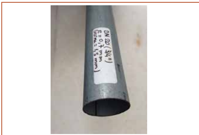
Exemplo de eletroduto de aço fora de norma, com parede 0,7mm, quando deveria ser 1,5mm.
