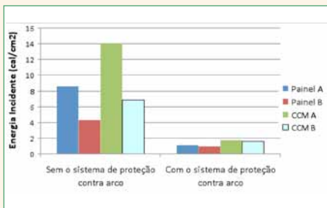
Figura 3 – Comparativo entre energias incidentes com e sem o sistema de proteção contra arco elétrico, considerando 85% da corrente do arco.
