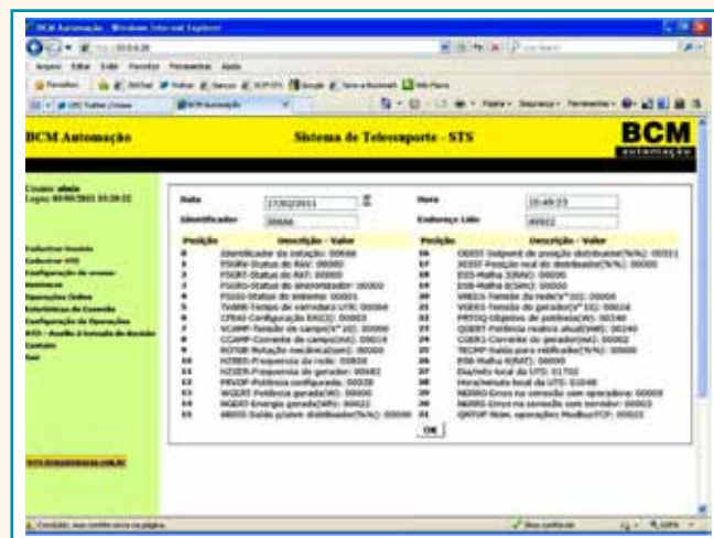
Figura 4 – Website do STS, mostrando um registro de variáveis do sistema de controle de PCH.
