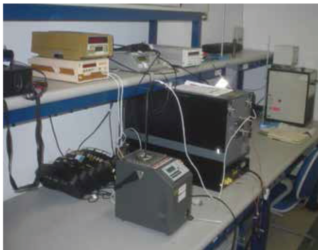
Figura 8 - Fornos para calibração de sensores de temperatura.
