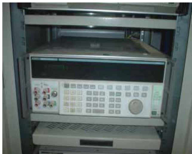
Figura 9 - Padrão de calibração de grandezas elétricas.
