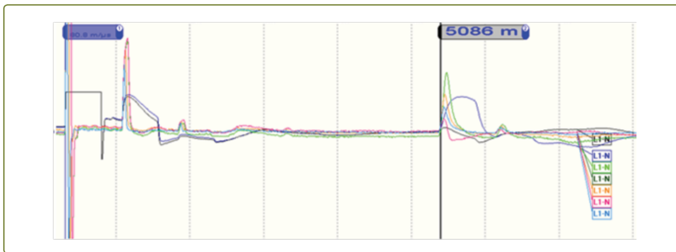
Figura VII: Exemplo de reflectometria em cabo com indício de falha no trecho inicial.
