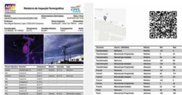
Figura 2 - Exemplo de relatório de termovisão com alarme para manutenção imediata.À esquerda, fotos termográfica e óptica; À direita, relação dos elementos detectados nas imagens, suas temperaturas e um QRcode que ao ser lido, permite localizar o endereço onde as imagens foram feitas, através do Google StreetView
