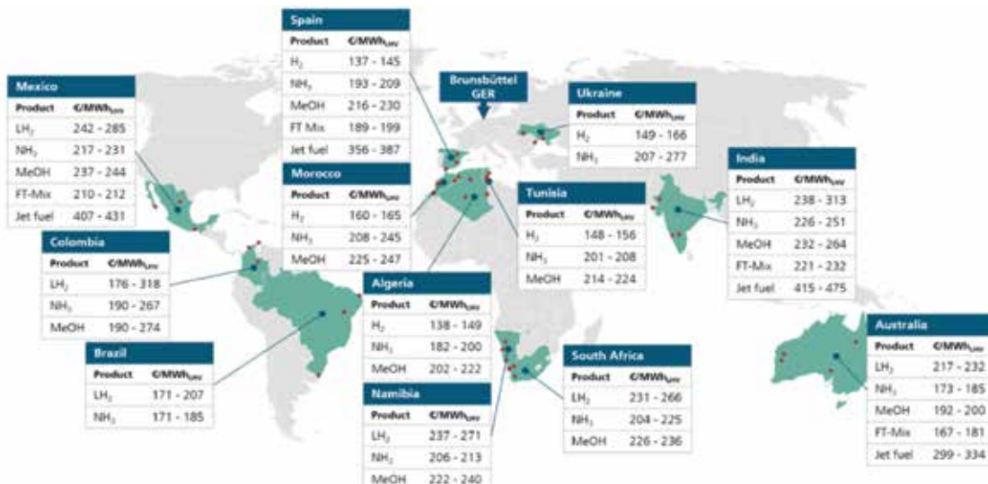
Figura 7 - Visão geral para todos os países avaliados do custo de fornecimento de transportadores de energia PtX, incluindo o seu transporte para a Alemanha.
