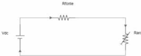
Figura 3 – Circuito elétrico equivalente resistência de arco variável.
