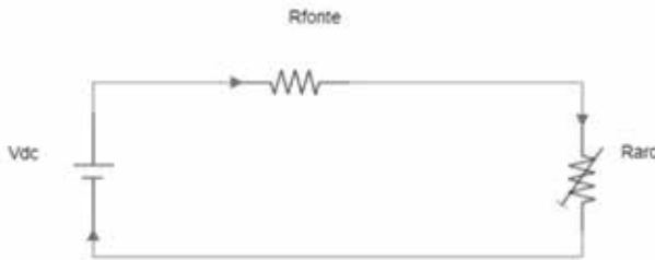
Figura 3 – Circuito elétrico equivalente resistência de arco variável.
