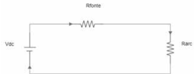
Figura 1 – Representação do esquema de arco elétrico em corrente contínua.
