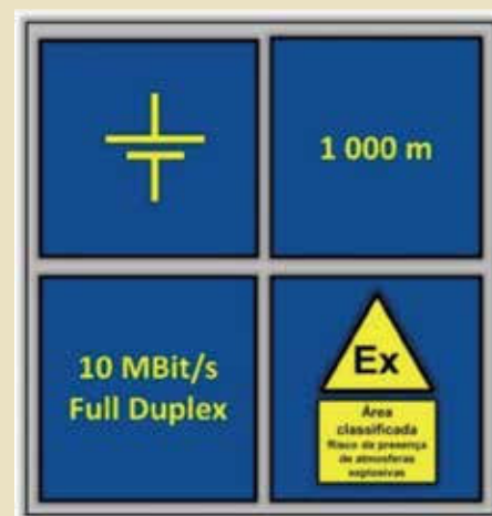
Figura 1: principais características dos equipamentos e sistemas no padrão Ethernet APL/2-WISE.
