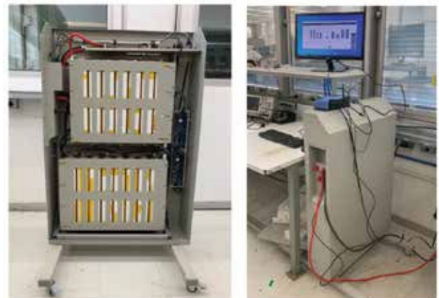
Figura 4 – Bateria second-life desenvolvida – visão da bateria aberta e em operação.
