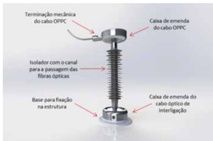
Figura 1 - Isolador óptico elétrico 138 kV.
