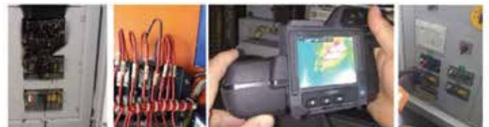
Figura 3 – Elevação de temperatura em circuitos de corrente.
