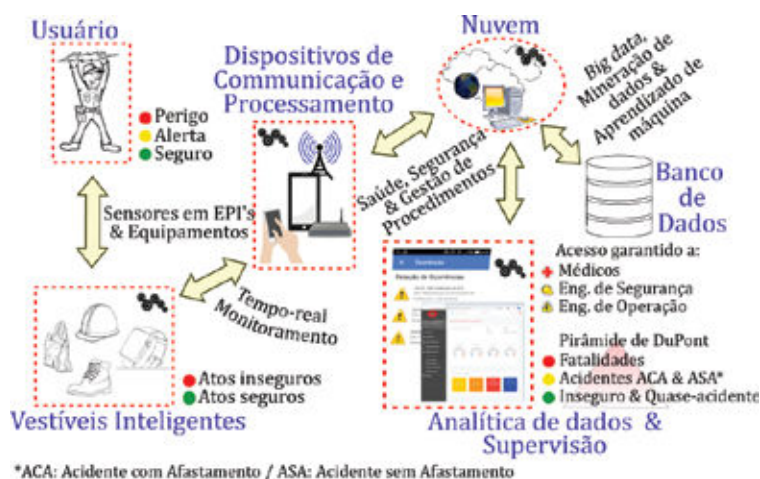
Figura 2 - Visão geral da aplicação de detecção em coisas e vestíveis, o Trabalhador Conectado Inteligente [16]
