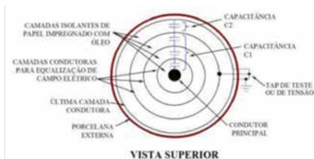
Figura 1 – Vista superior das camadas de bucha condensiva do tipo papel-óleo. Fonte: Treotech (2018).
