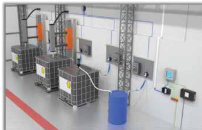
Aterramento de IBC conectado a um sistema de terra e tubulações de processo, com sistema de monitoração, alarme e intertravamento em caso de falha no aterramento durante operações de enchimento ou esvaziamento.
