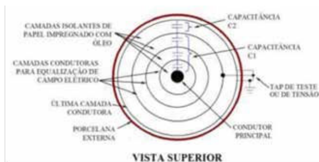
Figura 1 – Vista superior das camadas de bucha condensiva do tipo papel-óleo. Fonte: Treetech (2018).
