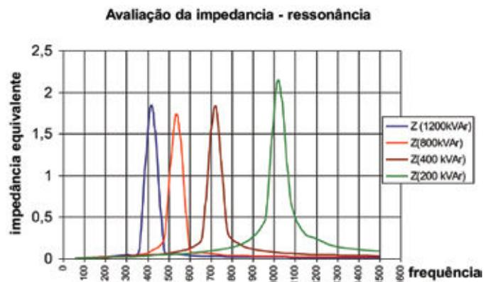
Figura 2 – Gráfico da Impedância em função da frequência harmônica. Fonte: o autor.
