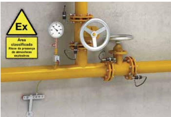
Figura 2 - Exemplo de ligação equipotencial por meio de barra de equipotencialização e centelhadores encapsulados com certificação "Ex".
