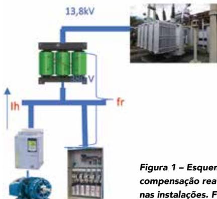
Figura 1 – Esquemático de compensação reativa e harmônicas nas instalações. Fonte: o autor.
