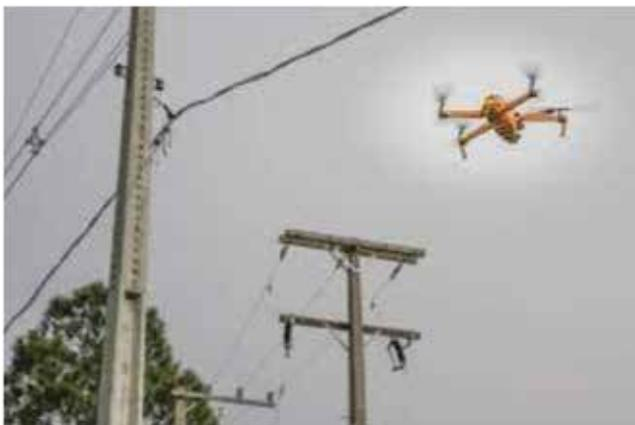
**Figura 7 – Aplicação de drones para inspeção em redes de distribuição.**
