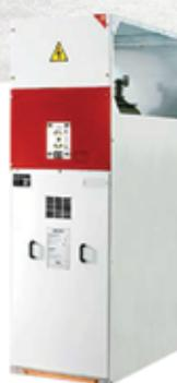
Cubículos classes 17,5kV, 24kV e 36kV, 16kA, compacto com isolamento a ar e seccionadoras em SF6, resistente ao arco interno.
