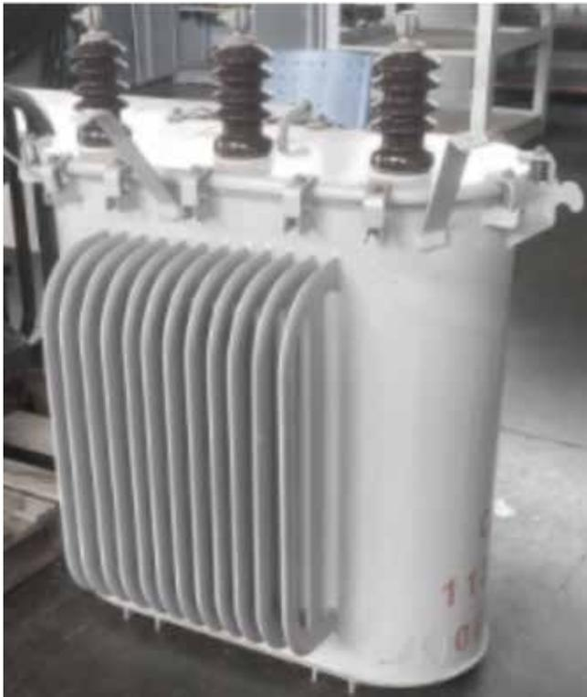
Figura 2 – Transformador de serviços auxiliares.
