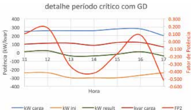
Figura 4 – Detalhamento da figura 3 em período de injeção de GD-FV.
