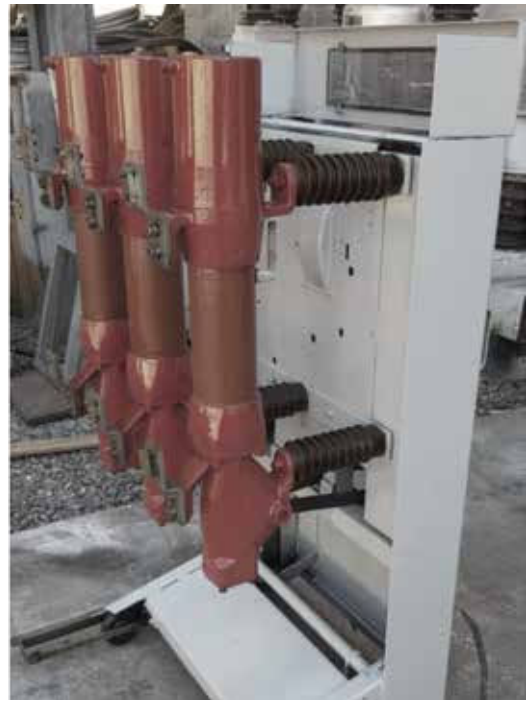
Figura 4 – Disjuntor de alta tensão do tipo PVO.
