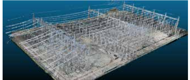
Figura 5 – Nuvem de pontos completa da Subestação Bateias.
