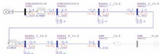
Figura 7 – Fluxo de carga – sem a UFV 0,60 MW e TAPs congelados.
