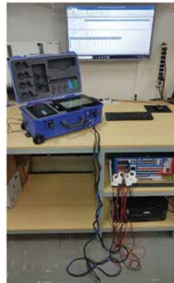
Figura 4 - Estrutura laboratorial de testes do medidor.
