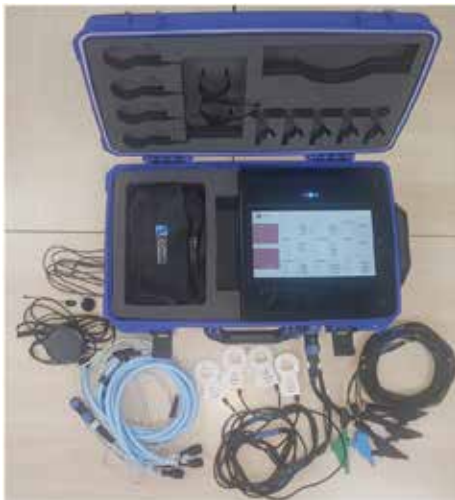
Figura 3 - Analisador de Qualidade da Energia Elétrica contemplando a metodologia UFU de agregação de ângulos de fase de componentes harmônicas.
