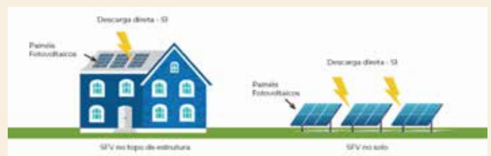
Figura 4 – Fonte de danos S1 em SDFV no topo de estruturas e no solo.
