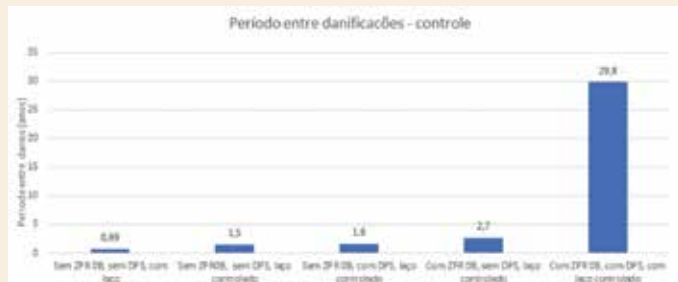
Figura 8 – Períodos prováveis entre falhas (anos) do sistema de supervisão e controle de uma usina fotovoltaica típica de 6 MWp em local com N_g = 5 descargas / km 2 ano em várias situações de infraestrutura de proteção da rede de supervisão.
