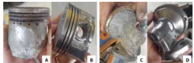
Figura 3 – Peças metálicas após a limpeza com desengraxantes convencionais (A e C) e com o biodegreante (B e D).
