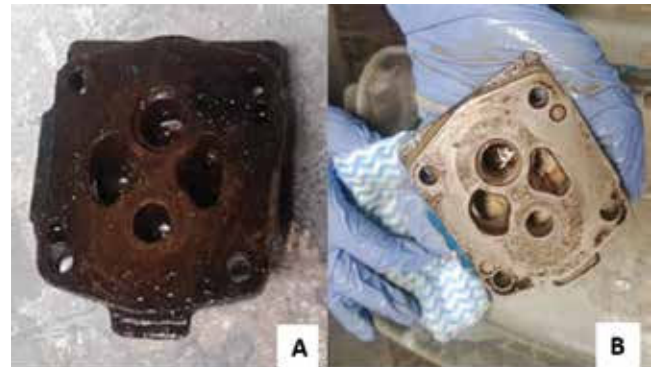
Figura 2 – Peça metálica antes (A) e após (B) limpeza com biodegreante.
