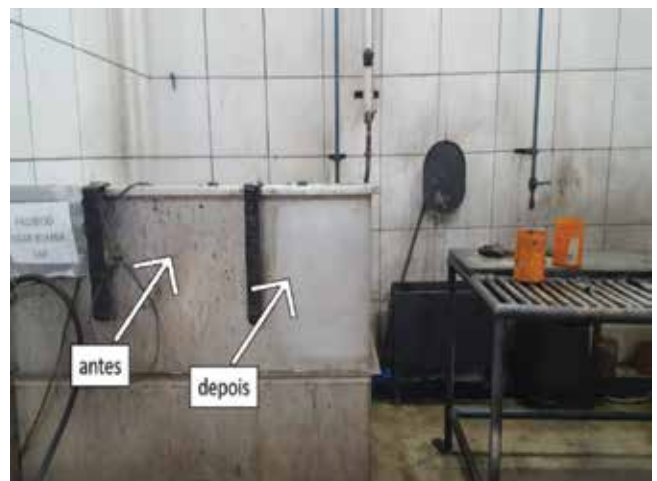
Figura 4 – Limpeza de um tanque metálico utilizado para imersão de peças impregnadas com óleo antes e depois do uso do biodegreante.
