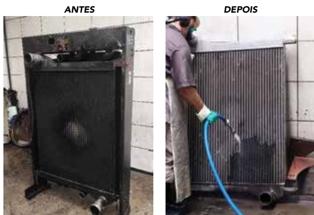
Figura 5 – Limpeza de peça metálica do motor impregnada com óleo antes e depois do uso do biodetergente.
