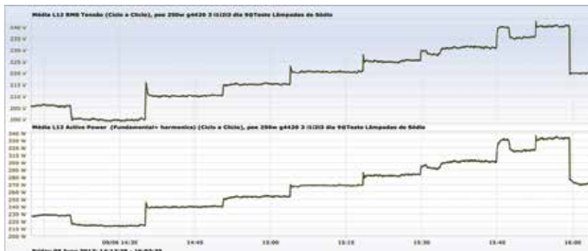
Figura 1 – Variação da potência em função da variação de tensão em lâmpada a vapor de sódio de característica de corrente constante.
