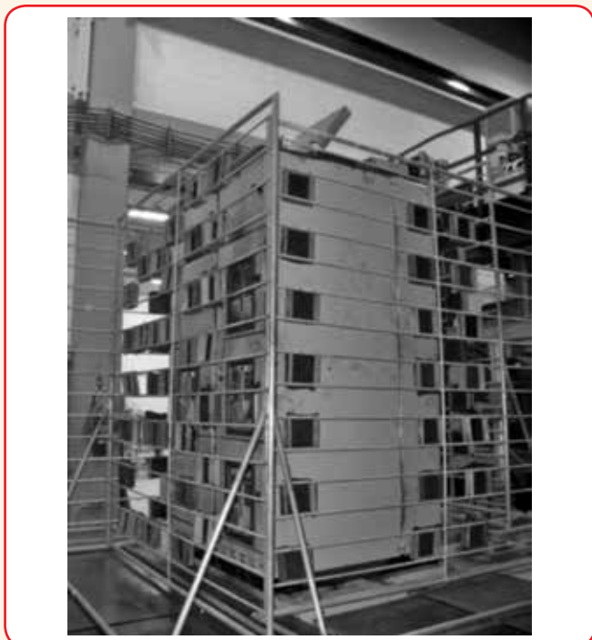
Figura 4 – Arranjo dos indicadores verticais para verificação dos efeitos térmicos dos gases.
