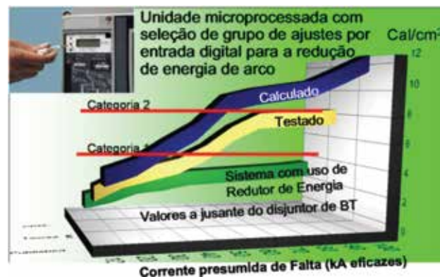
Figura 4 – Redução da energia incidente pela alteração dos ajustes da proteção durante uma intervenção.
