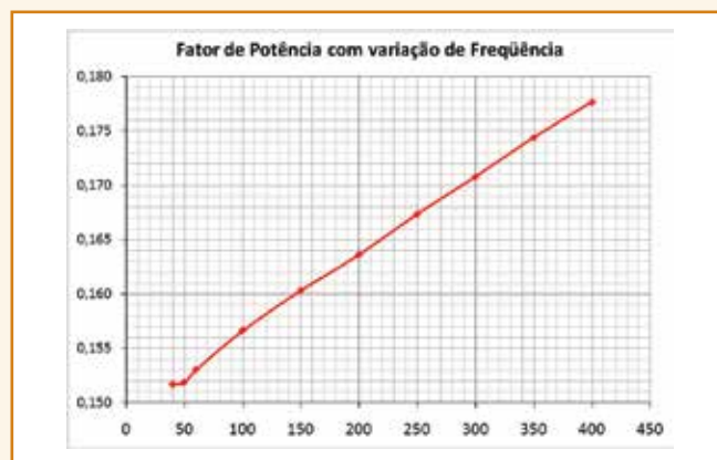
Figura 8 – Fator de potência para transformador novo de 69 kV.
