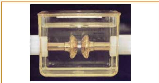
Figura 6 – Cuba de medidor de rigidez dielétrica com eletrodos VDE.
