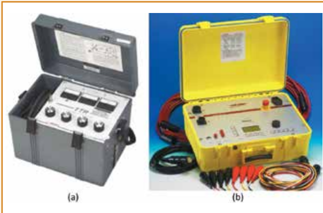
Figura 4 – TTR, (a) analógico monofásico (MEGGER), (b) trifásico digital (RAYTECH).
