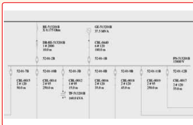
Figura 3 – Diagrama unifilar simplificado, mostrando parte dos turbogeradores de uma unidade petroquímica.
