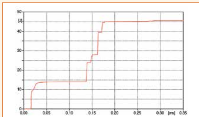
Figura 8 – Energia no para-raios de 13,8 kV do TR-01.
