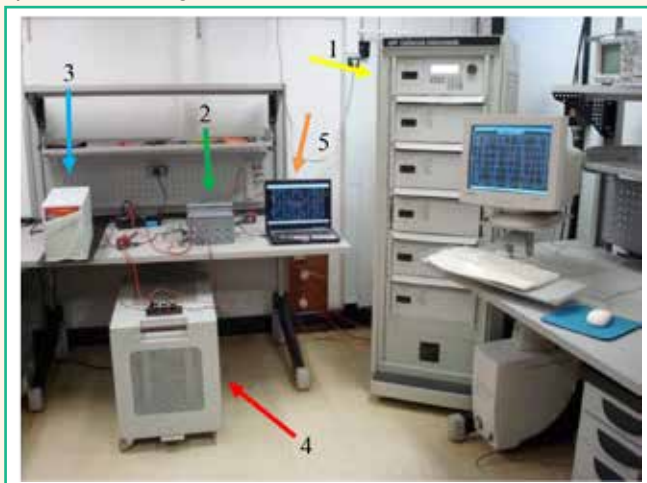
Figura 8 – Montagem utilizada para avaliação de UPSs estáticos frente aos cortes de tensão (notching).
