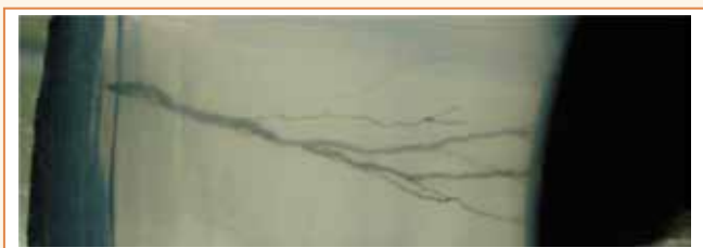
Figura 4 – Foto microscópica do fenômeno “electrical trees”.
