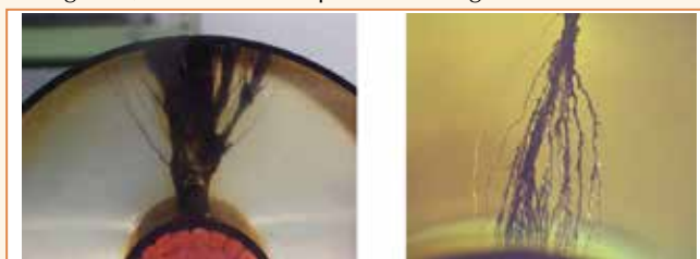
Figura 5 – Imagem microscópica de descargas em arborescência elétrica.
