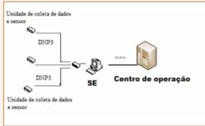
Figura 8 – Arquitetura do sistema de automação.
