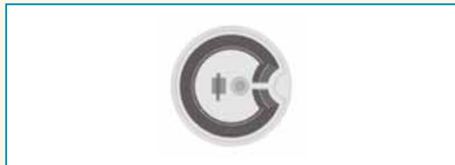
Figura 4 – Tag RFID que fica inserido no interior da Lingueta de contato.
