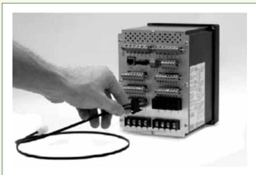
Figura 1 – Conexão de um sensor pontual de luz em um relé de proteção digital comercial.
