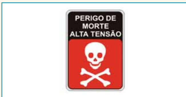
Figura 4 – Placas de aviso devem ser posicionadas em locais visíveis e do lado externo ao acesso.
