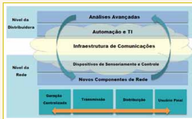
Figura 3 – Componentes da rede inteligente.
