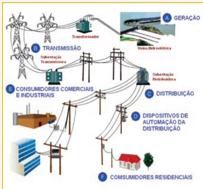
Figura 1 – Sistema elétrico convencional.
