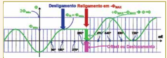
Figura 5 – Fluxo remanescente após a desenergização e energização.
