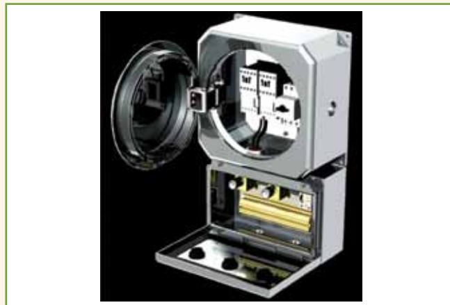
Figura 11 - Exemplo de montagem de painel de força e comando com invólucros metálicos com juntas roscadas e entradas indiretas de cabos. Vantagens: dispensa a necessidade de grande quantidade de parafusos de fixação das tampas e de unidades seladoras nas entradas de eletrodutos. Entradas indiretas por meio de buchas de passagem Ex “d” seladas de fábrica e de bornes terminais Ex “e” externos ao invólucro à prova de explosão.
