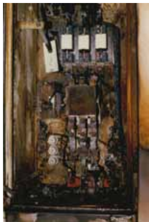
Figura 10 – Curto à terra por arco em uma gaveta de 480 V.
