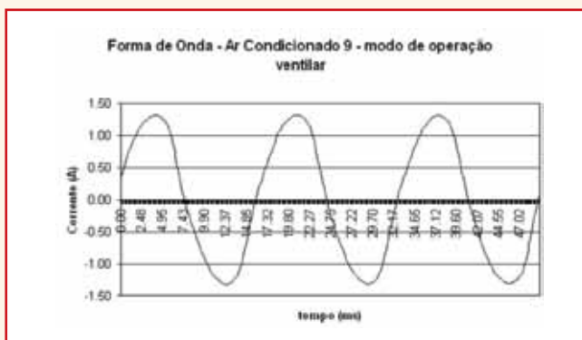
Figura 4 - Forma de onda de corrente de um condicionador de ar (modo ventilar).
