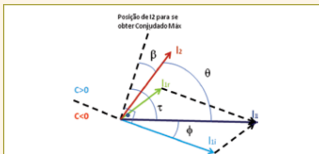
Figura 6 – Correntes I_1 e I_2 em um relé de disco de indução e respectivos ângulos
