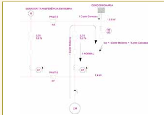
Figura 22 – Coordenação do relé 67 com o(s) relé(s) 50/51
