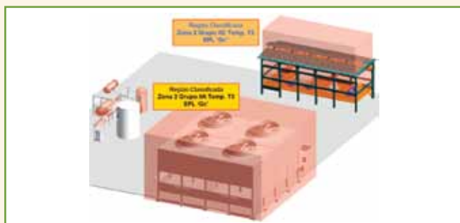
Maquete eletrônica em CAD 3D, baseada em banco de dados orientados a objetos, de torre de resfriamento de água industrial, incluindo áreas classificadas
