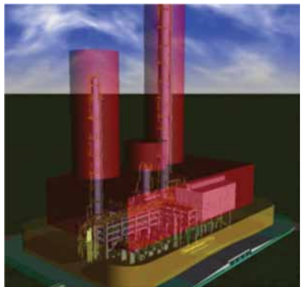
Estudo de classificação de áreas de unidade de propeno, em planta petroquímica, elaborado em maquete eletrônica em CAD 3D, contendo atmosferas explosivas dos tipos Zonas 1 e 2, EPL Gb e Gc e Grupos IIA e IIB (ABNT NBR IEC 60079-10-1)
