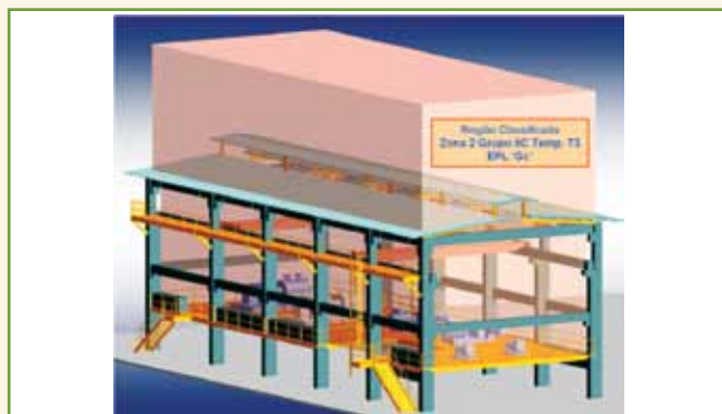
Projeto de maquete eletrônica em CAD 3D de Casa de Compressores de Hidrogênio incluindo áreas classificadas, baseada em banco de dados orientados a objetos
