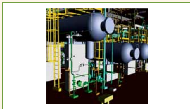
Projeto de unidade de processo industrial utilizando maquete eletrônica em CAD 3D baseada em banco de dados orientados a objetos, mostrando equipamentos de processo, tais como vasos, tubulações e válvulas de controle
