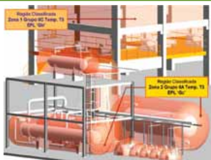
Vista isométrica de maquete eletrônica em CAD 3D baseada em banco de dados orientados a objetos, de vasos, permutadores e casa de compressores incluindo áreas classificadas
