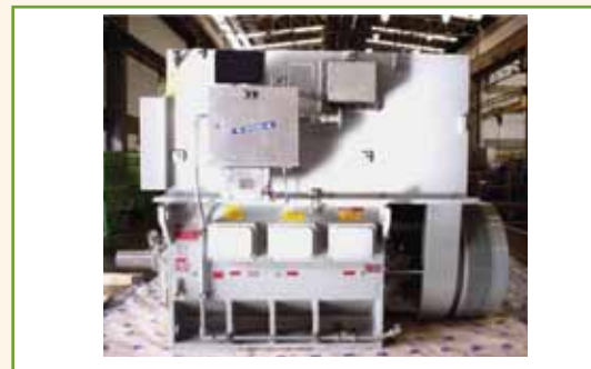
Figura 1 - Motor Ex pz EPL Gc com tensão nominal de 4,16 kV e invólucro pressurizado para instalação em áreas classificadas do tipo Zona 2
