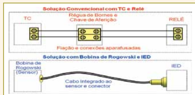
Figura 20 – Comparação dos tipos de solução (instalação) convencional com TC e relé versus bobina de Rogowski e IED.
